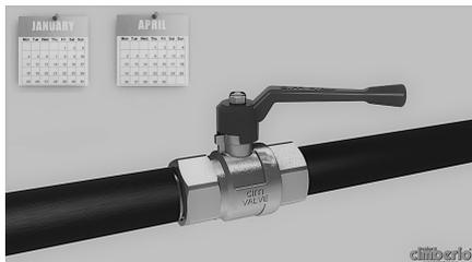
Effettuare un ciclo completo di manovra almeno una volta ogni tre mesi, per prevenire la formazione di depositi calcarei, tali da bloccare il funzionamento
