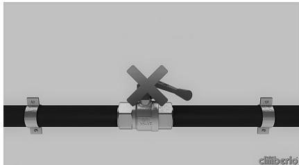
Non utilizzare le valvole come organo di regolazione, ma solo di intercettazione per evitare il danneggiamento dei seggi.
