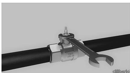
Nel caso di trafilamenti dall'asta, rimuovere la leva di manovra svitando il dado e stringere il premistoppa. Nel caso la perdita continuasse, svitare il premistoppa, controllare lo stato delle guarnizioni in PTFE.
