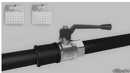
Effettuare un ciclo completo di manovra almeno una volta ogni tre mesi, per prevenire la formazione di depositi calcarei, tali da bloccare il funzionamento
