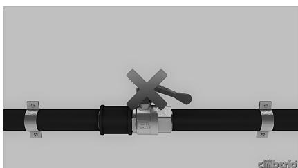
Non utilizzare le valvole come organo di regolazione, ma solo di intercettazione per evitare il danneggiamento dei seggi.
